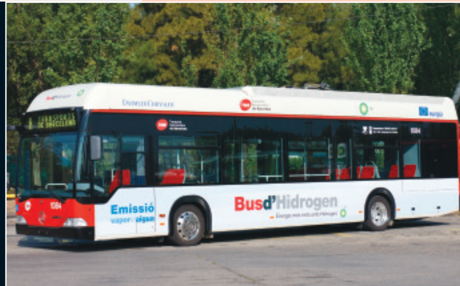
Bus Mercedes de pila d'hidrogen.
