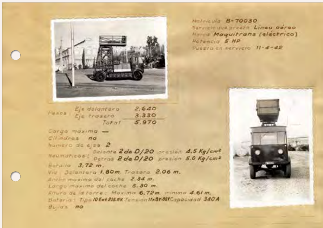
Fitxa tècnica d'un camió torre de 1942 construït a partir de peces d'autobús Tilling-Stevens. Autor desconegut. Arxiu Fundació TMB
