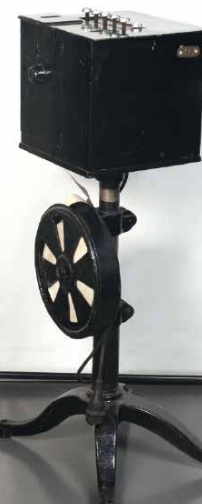
Màquina NATIONAL Expedidora de bitllets manual. F.C. Metropolità de Barcelona, SA
